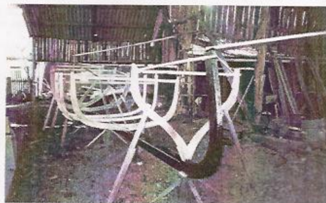
Vista desde a popa da lancha, coas cademas falsas feitas en piñeiro do país, listas para embarrotar para mirarlle a fasquia a lancha e facer as correccións que se queiran
