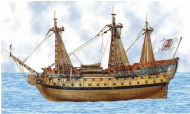
O navio Galicia de 70 canóns, construído no Ferrol en 1730 precisou dunhas 2.600 árbores na súa construción. Un de 80 canóns xa consumía unhas 3.500.
