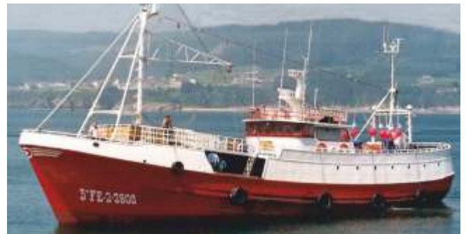
Un dos últimos "gransoleiros" de casco de madeira con sobreestrutura metálica adaptada
