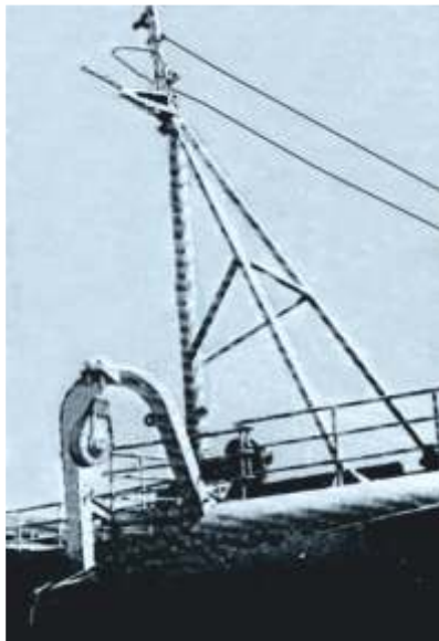
Amura de estribor dun arrastreiro de costado co pescante (gallows) de proa
