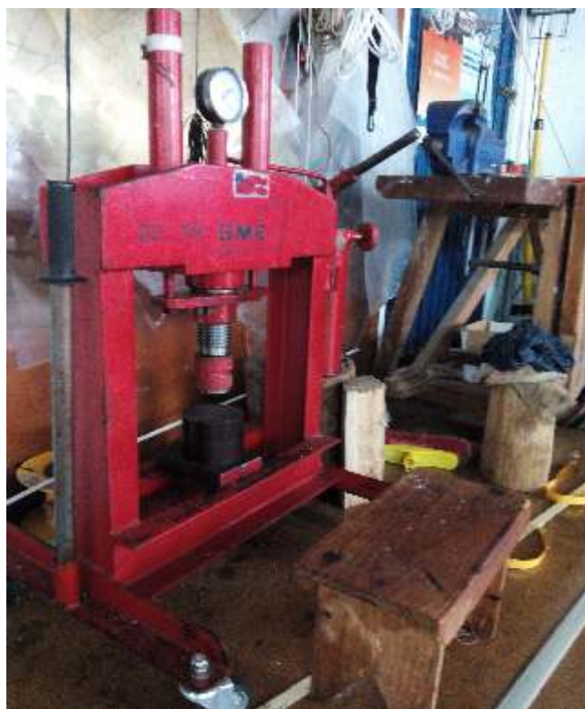
Prensa rematadora dos ollais
